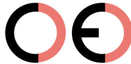
Falsche CE-Kennzeichnung (zu großer Zwischenraum)
